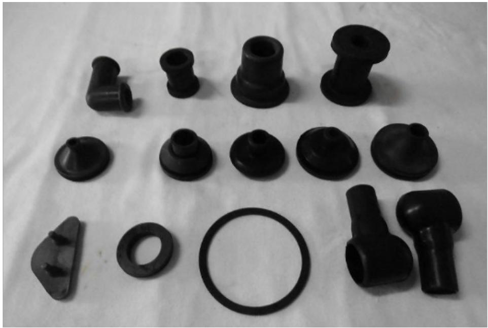
氯丁胶CR(Neoprene Polychloroprene) 由氯丁烯单体聚合而成. 硫化后的橡胶弹性耐磨性好, 不怕阳光的直接照射, 有特别好的耐候性能, 不怕激烈的扭曲, 不怕制冷剂, , 耐稀酸、耐硅酯系润滑油, 但不耐磷酸酯系液压油. 在低温时易结晶、硬化, 贮存稳定性差, 在苯胺点低的矿物油中膨胀量大. 一般使用温度范围为-50~150 °C. 优点: 弹性良好及具良好的压缩变形, 配方内不含硫磺因此非常容易来制作. 具抗动物及植物油的特性, 不会因中性化学物, 脂肪、油脂、多种油品, 溶剂而影响物性, 具防燃特性。
